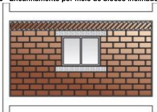
Figura 6 - Encunhamento por meio de blocos inclinados
