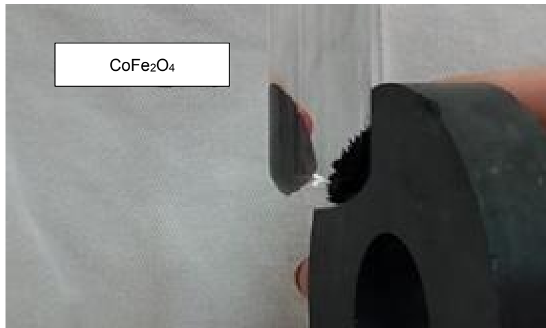
Figura 8 - Separação magnética de partículas de \text{CoFe}_2\text{O}_4 dispersas em água
