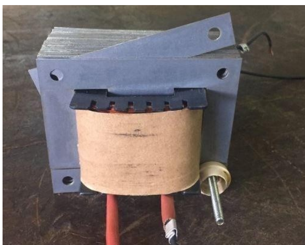
Figura 15 – Processo de colocação dos parafusos
