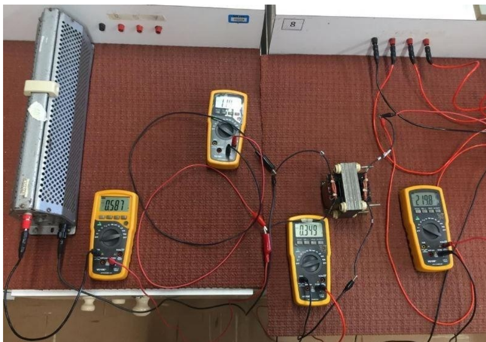
Figura 19 – Teste das tensões e correntes com carga resistiva
