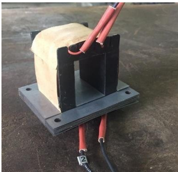
Figura 14 – Processo de montagem das chapas EI
