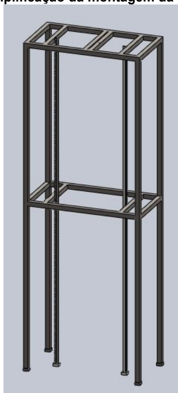
Figura 10 – Exemplificação da montagem da estrutura da caixa
