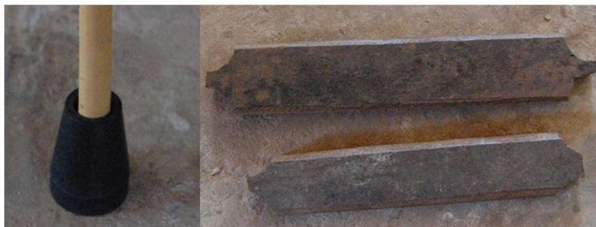
Figura 18: Peça de borracha (pé da muleta) e travessas de madeira (suporte mão e axila).
