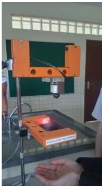
Figura 10 - Aparelho para medir tempo e distância com a utilização de foto sensores
