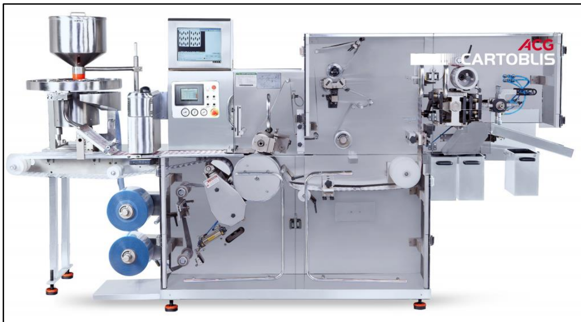
Figura 4 - Modelo do equipamento (emblistadeira de comprimidos) utilizada no processo de emblistamento dos lotes utilizados no estudo.
