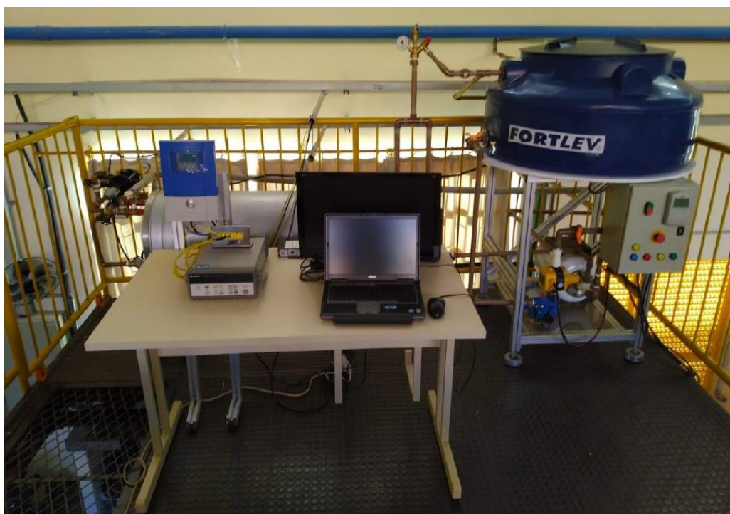
Fotografia 4 – Sistema fechado de circulação de água a alta pressão
