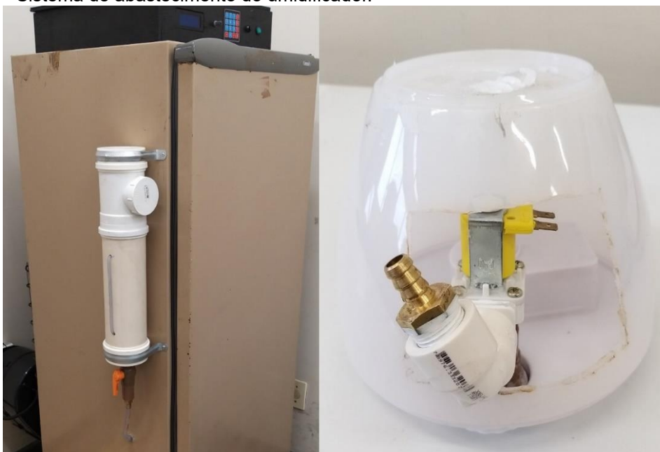
Figura 35 – Sistema de abastecimento do umidificador.
