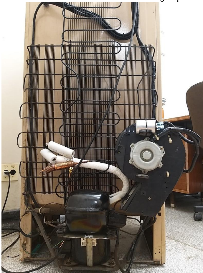
Figura 33 – Vista traseira dos condensadores dos sistemas de refrigeração e desumidificação.
