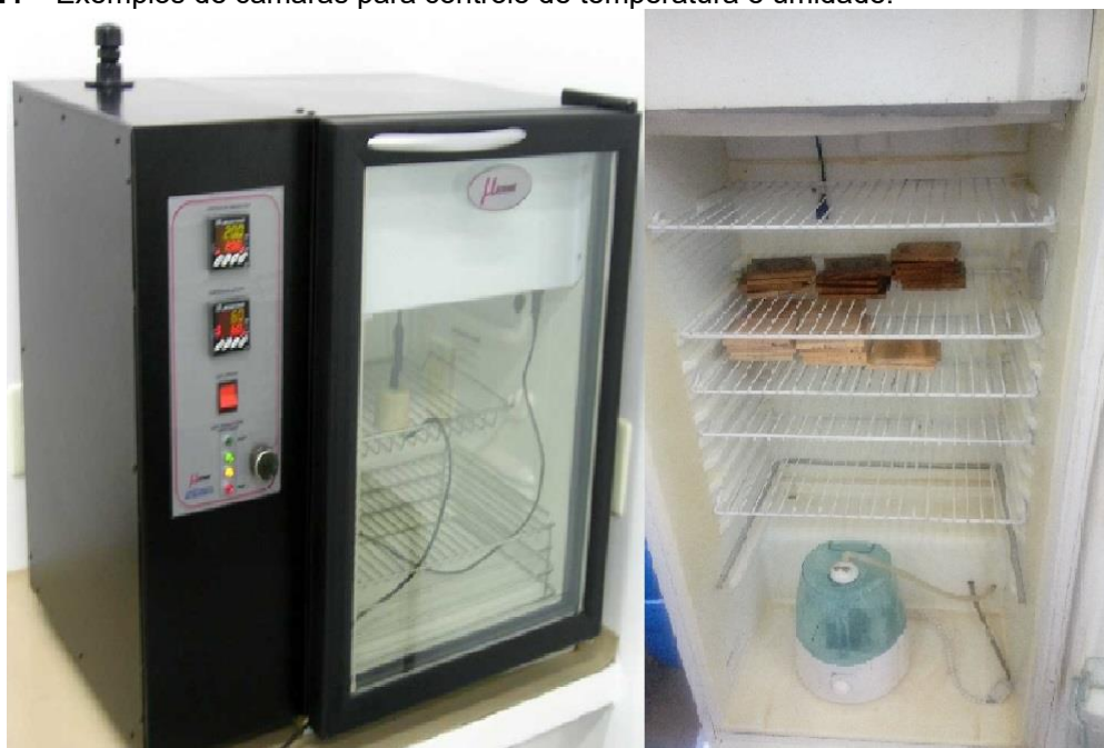
Figura 24 – Exemplos de câmaras para controle de temperatura e umidade.
