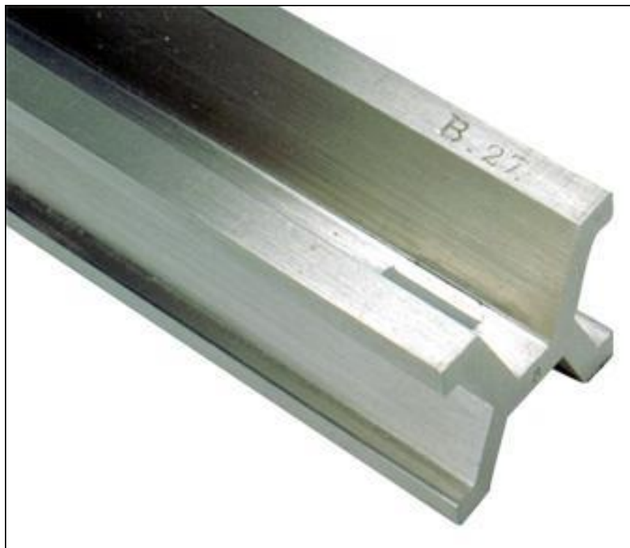
Figura 1 - A barra utilizada como protótipo internacional do metro de 1889 a 1960
