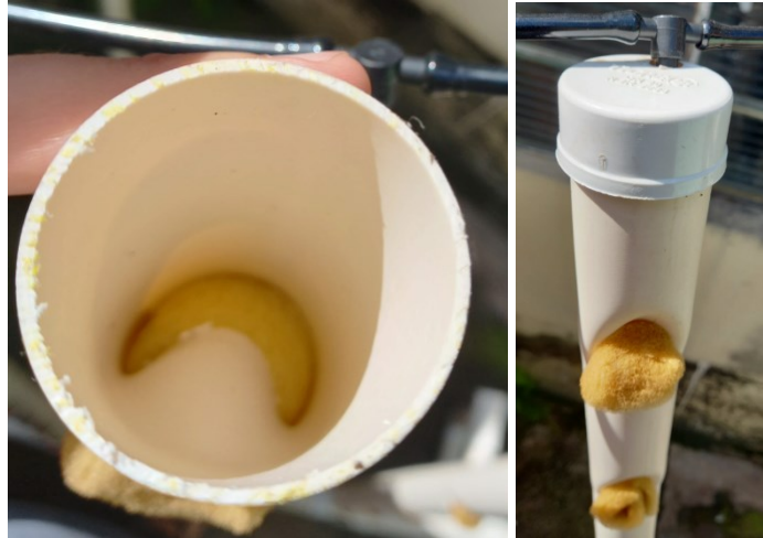
Figura 19: Restrição interna do tubo
