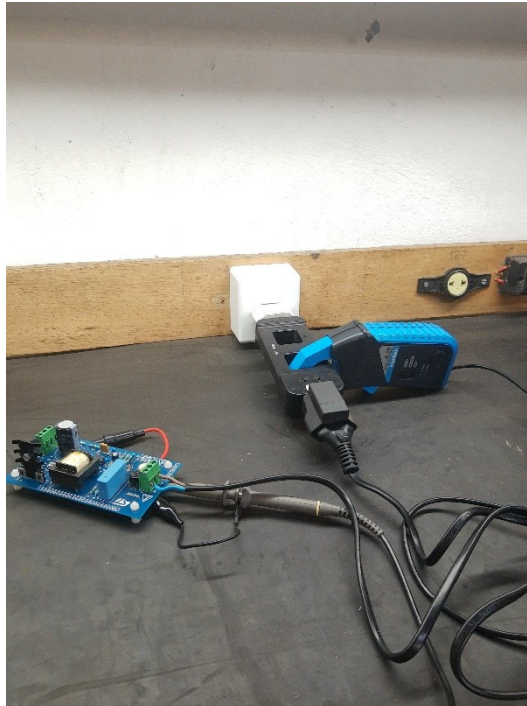
Figura 57 - Instalação para medição da corrente de entrada em relação a tensão de entrada
