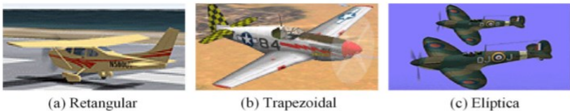
Figura 6 - Principais formas geométricas das asas
