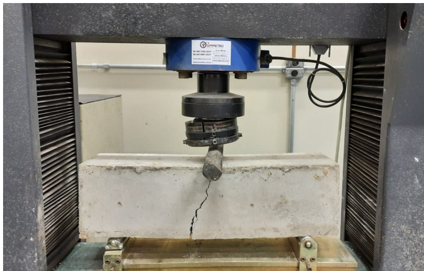
Figura 13 - Ensaio de viga em concreto convencional (REF) submetida à flexão.
