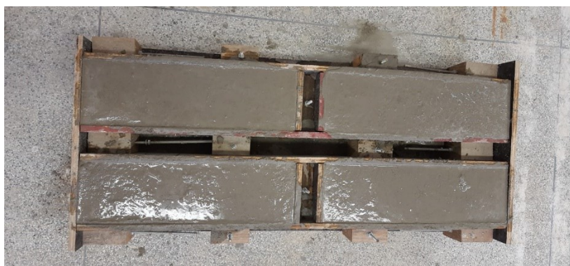
Figura 10 - Formas preenchidas com concreto fresco.
