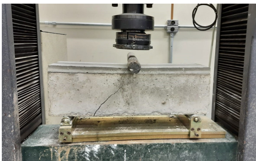
Figura 14 - Ensaio de viga em concreto reforçada (SUP).
