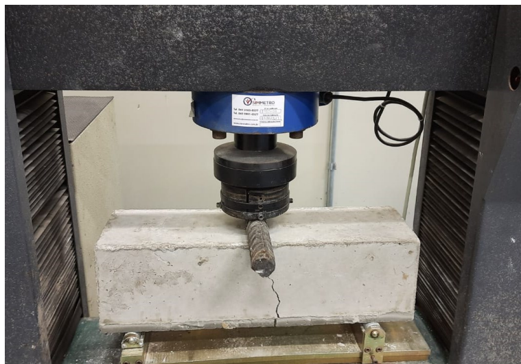
Figura 15 - Ensaio de viga em concreto reforçada (INF).
