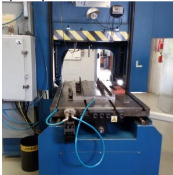
Figura 23 – Máquina utilizada no processamento de deposição superficial por atrito
