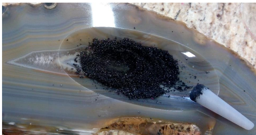
Figura 6 – Nanopartículas de cobalto antes da lavagem
