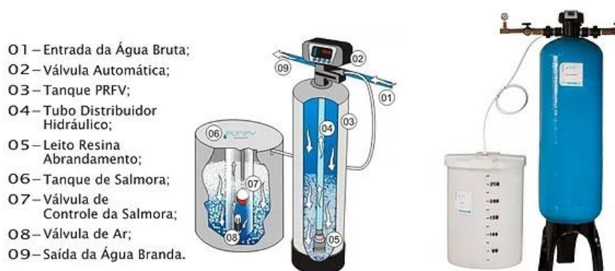
Figura 49 - Sistema de abrandador de água.
