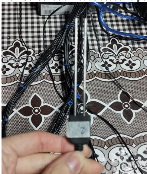
Figura 26 – Sensor de umidade usado na pesquisa.
