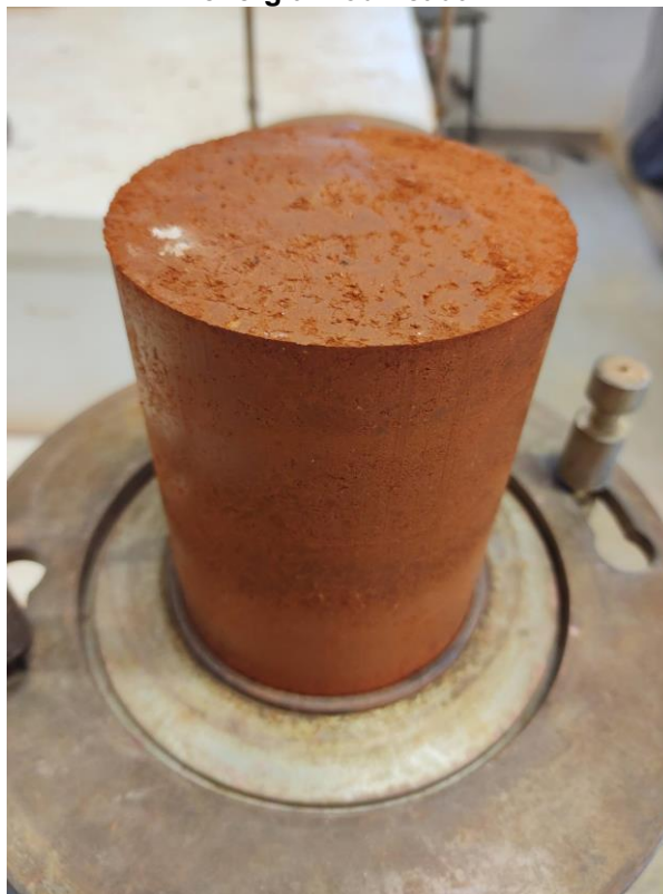
Figura 23 – Extração do corpo de prova próximo à umidade ótima para o solo siltoso na energia modificada.
