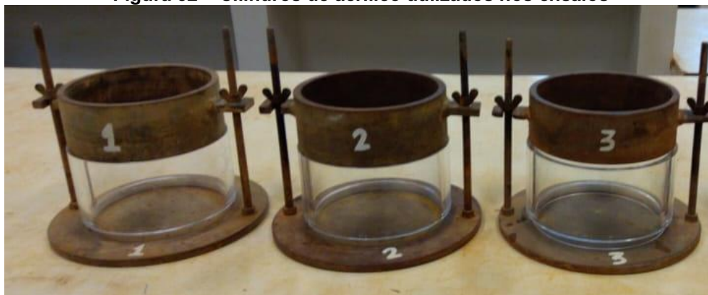
Figura 32 – Cilindros de acrílico utilizados nos ensaios
