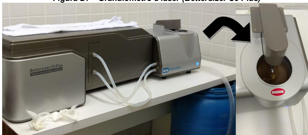
Figura 21 – Granulômetro a laser (Battersizer S3 Plus)
