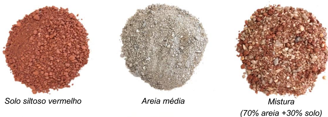
Figura 18 – Materiais que compõem à mistura desenvolvida para a pesquisa
