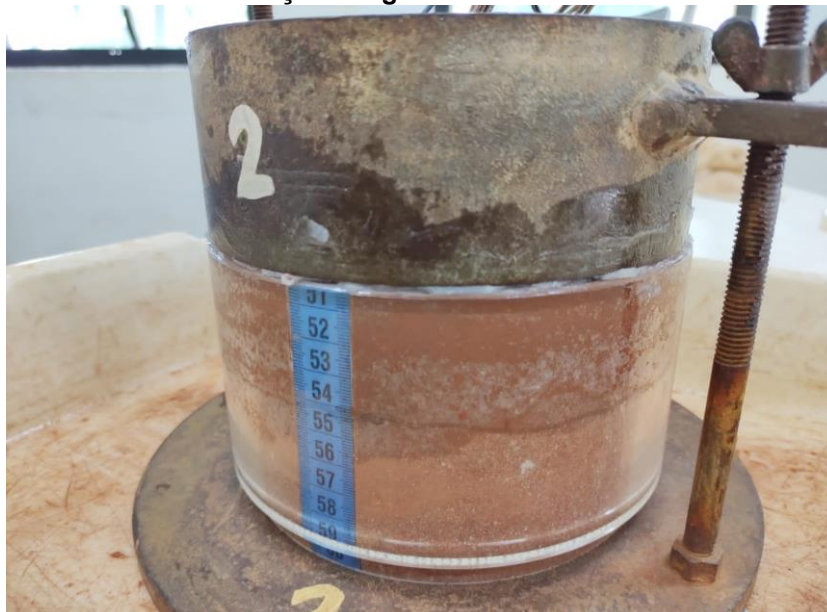
Figura 52 – Frente de saturação atingindo o sensor 3 no ensaio de verificação.
