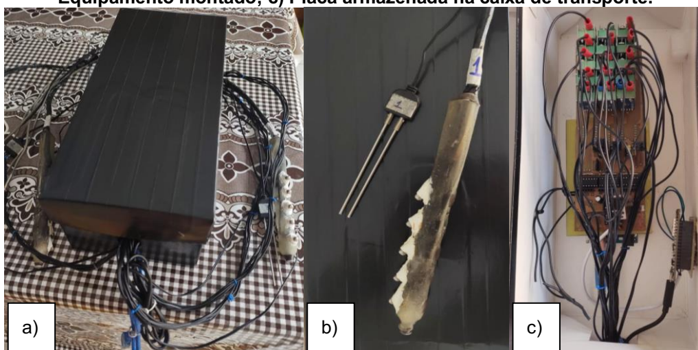
Figura 31 – Equipamento finalizado: a) Ponta de prova final e sensor de umidade; b) Equipamento montado; c) Placa armazenada na caixa de transporte.
