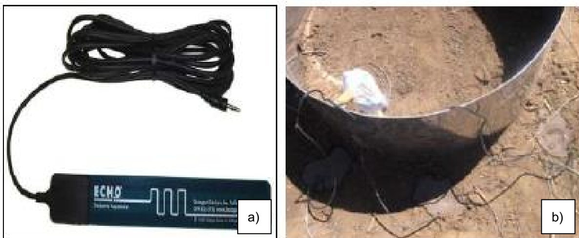
Figura 14 – a) Sensor de umidade ECH 2 O modelo EC-20; b) Sensores instalados no solo a três profundidades diferentes
