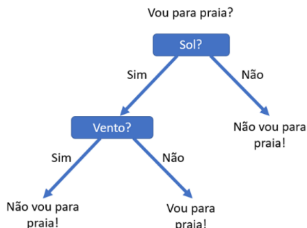
Figura 4 – Exemplificamos uma árvore de decisão extremamente simples, apenas com dois nós e poucos ramos.
