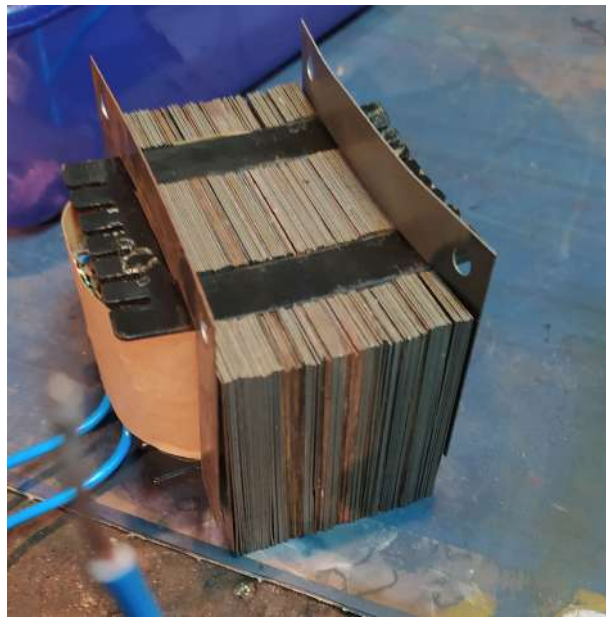
Figura 7: Inserção das chapas de aço-silício no carretel do indutor
