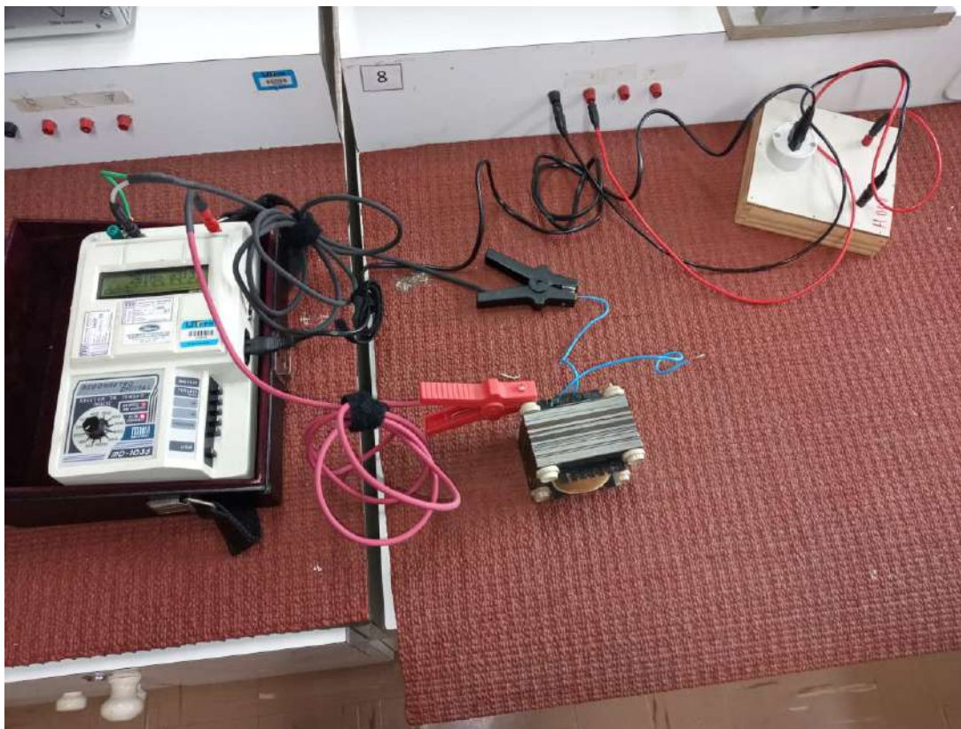
Figura 10: Ensaio de medição da resistência de isolamento
