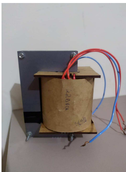
Figura 9 Transformador finalizado Fonte: Autoria própria (2021).
