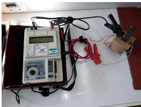
Figura 15 Medição com megôhmetro Fonte: Autoria própria (2021).
