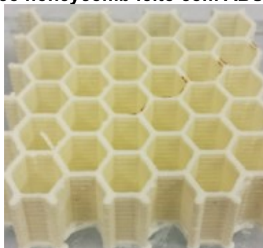
Figura 3 – Núcleo honeycomb feito com ABS através de FDM
