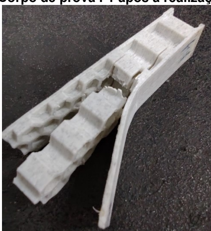
Figura 20 – Corpo de prova F1 após a realização do ensaio
