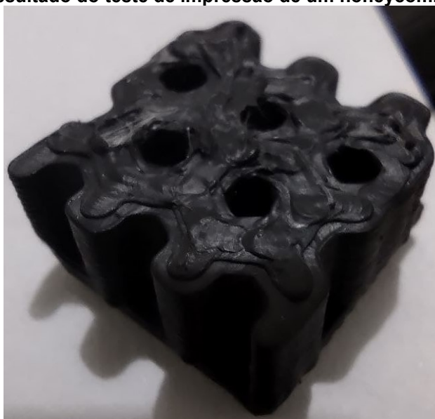
Figura 15 – Resultado do teste de impressão de um honeycomb pela Cube 3D
