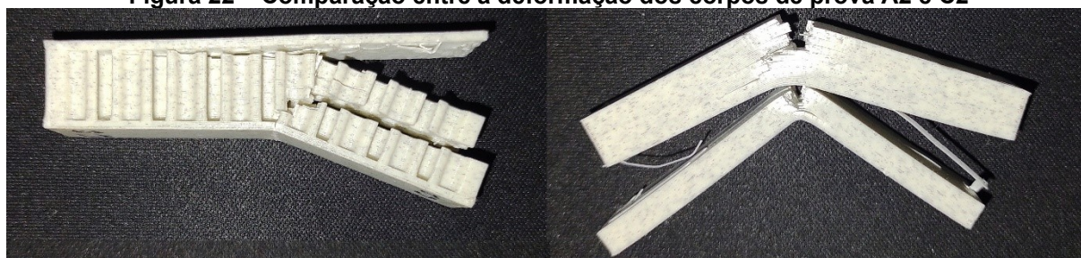
Figura 22 – Comparação entre a deformação dos corpos de prova A2 e C2
