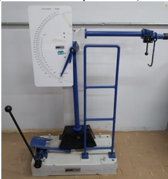
Figura 14 – Máquina de ensaio de impacto FIT-300, fabricada pela PANTEC
