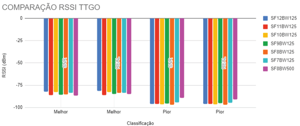
Figura 36 – Gráfico de comparação de melhor e pior RSSI com o dispositivo TTGO
