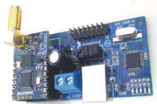
Figura 9 – Módulo LoRaWAN Radioenge acoplado com a interface USB
