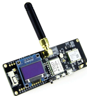
Figura 8 – Módulo TTGO com GPS e antena
