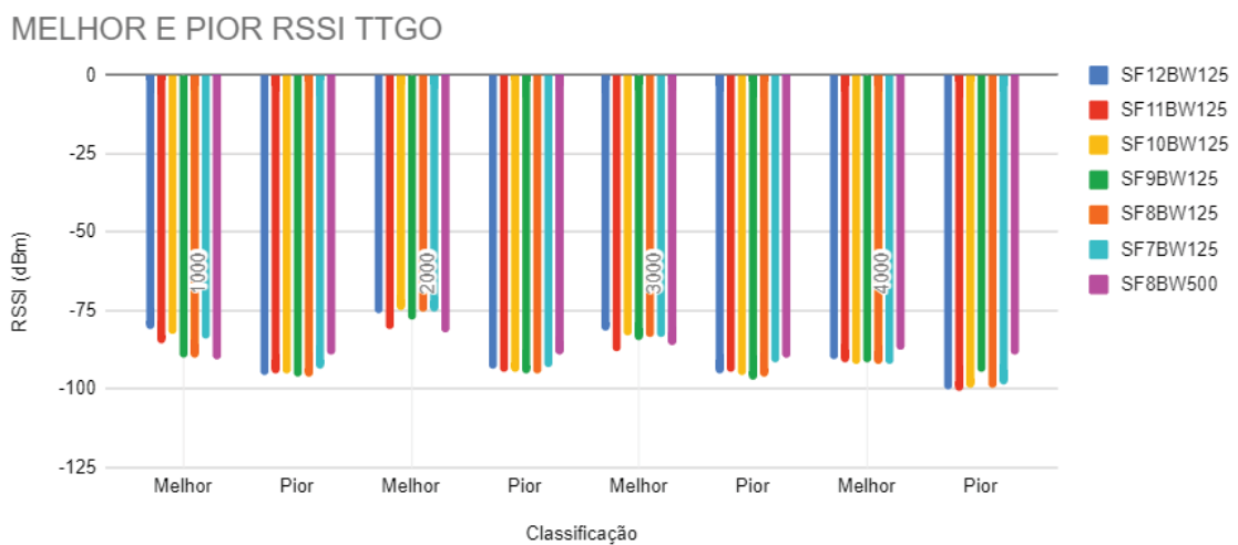
Figura 34 – Gráfico de medidas de melhor e pior RSSI com o dispositivo TTGO
