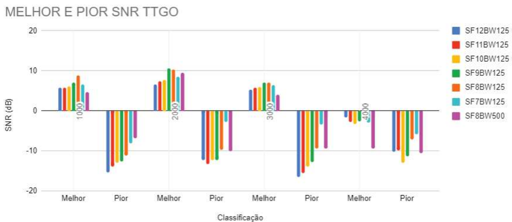
Figura 32 – Gráfico de medidas de melhor e pior SNR com o dispositivo TTGO
