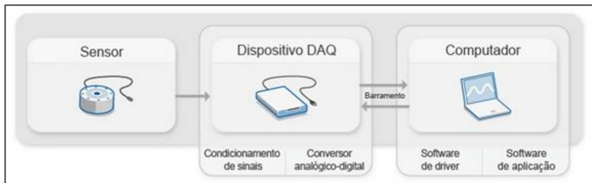
Figura 14 - Partes de um sistema de aquisição
