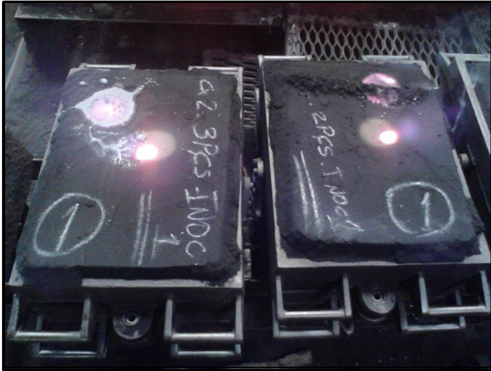
Figura 13 – Caixas com os corpos de prova, moldados, vazada Fonte: Autoria própria
