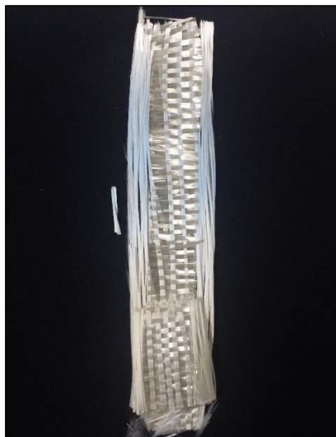
Figura 23 – Restos do CDP degradado – Fibras de Vidro Fonte: Autoria Própria (2015).
