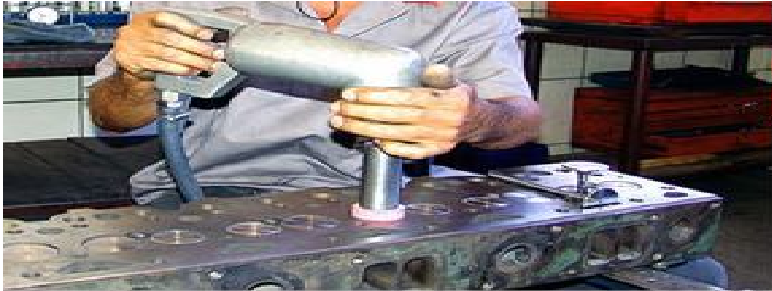
Figura 7 – Máquina semi manual retificadora de sedes de válvulas Fonte: Página da Monte Diesel.
