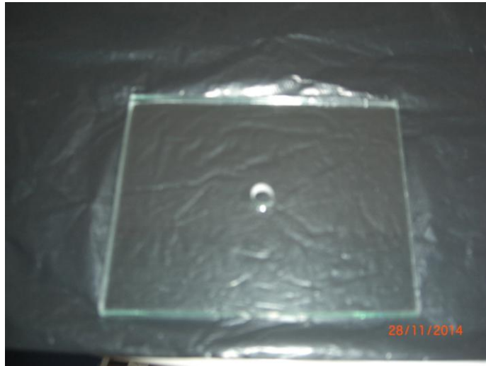
Figura 16: Placa de vidro utilizada para medição do volume da câmara de combustão.
