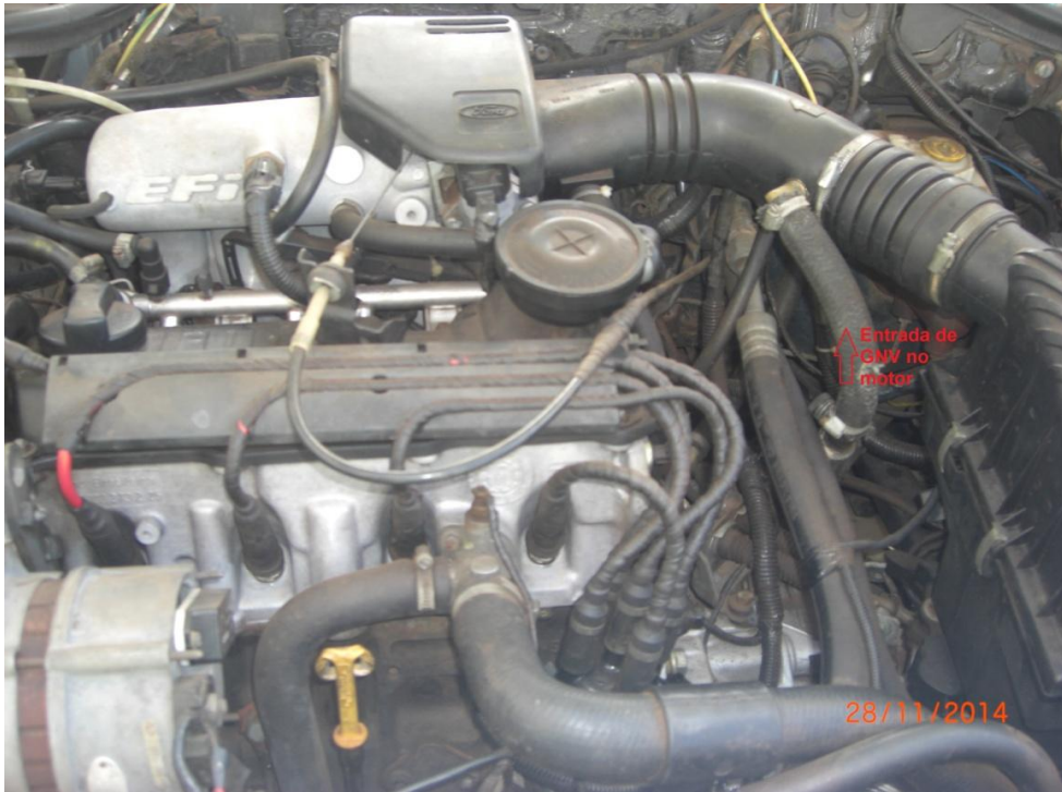
Figura 12: Entrada de GNV no motor AP 2.0 com injeção eletrônica EFI.
