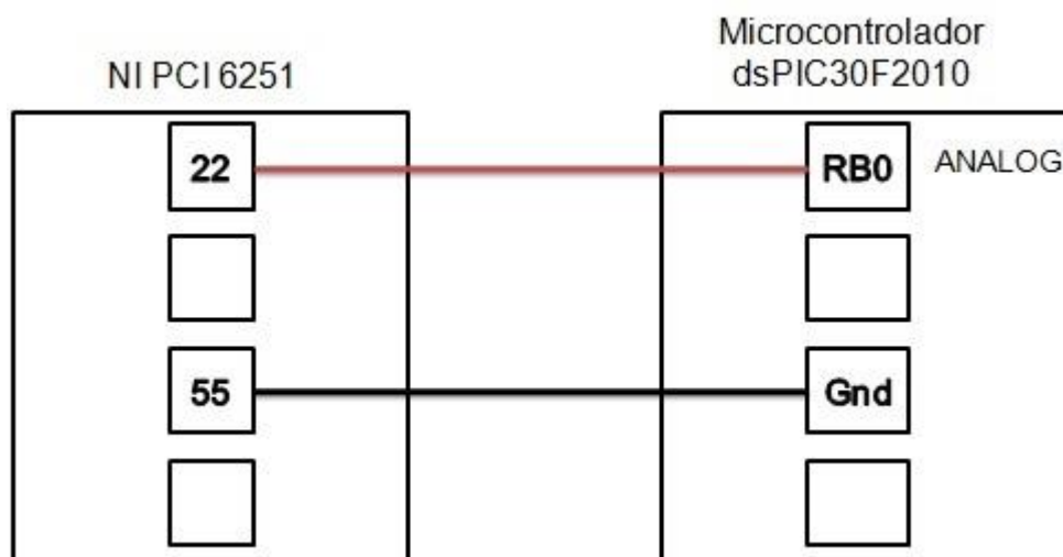
Figura 49 - Ligação NI PCI 6251 x dsPIC30F2010 Fonte: Autoria Própria.
