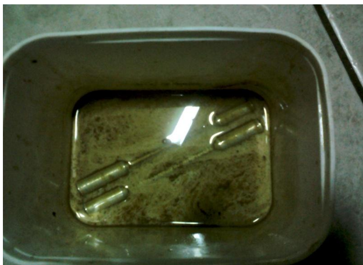
Figura 13 – Corpos de prova imersos em fluido de corte Fonte: Autoria própria
