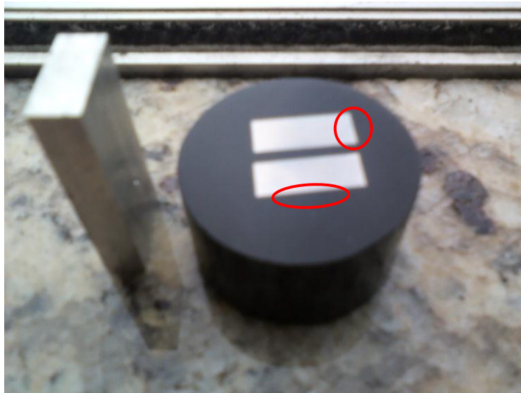
Figura 17 - Amostras pós-polimento para análise microscópica
