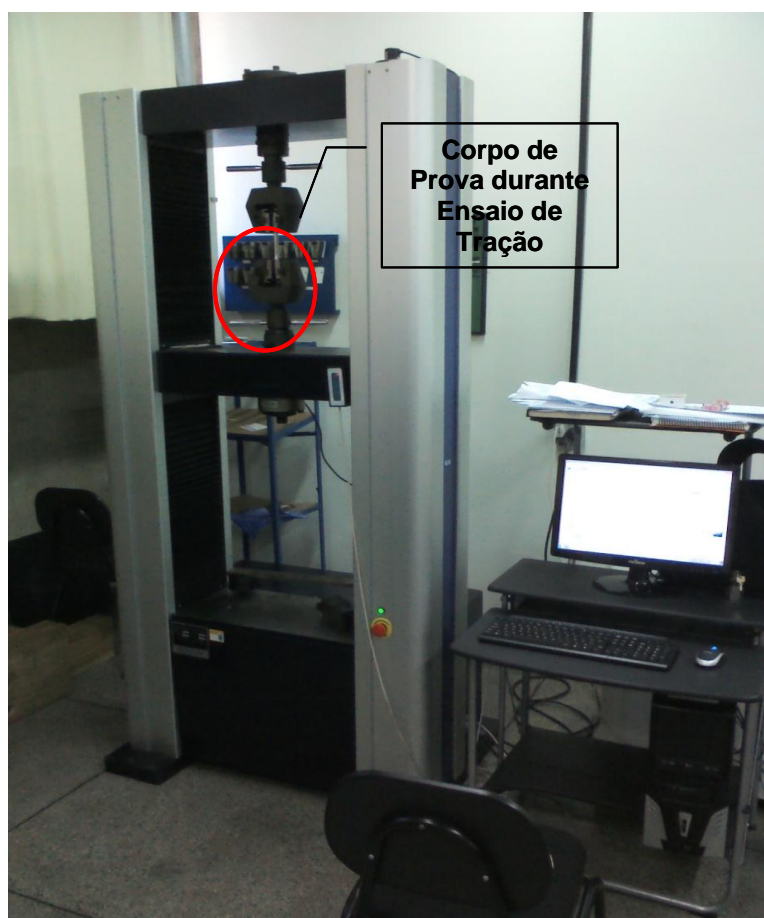
Figura 22 - Máquina utilizada para a realização do ensaio de tração Fonte: Autoria própria
