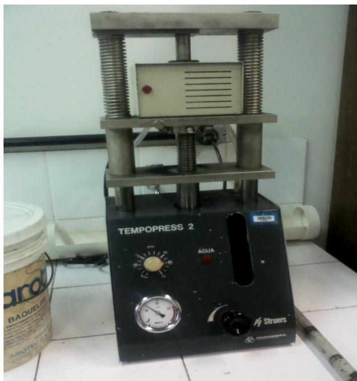
Figura 16 - Máquina utilizada para realização do embutimento
