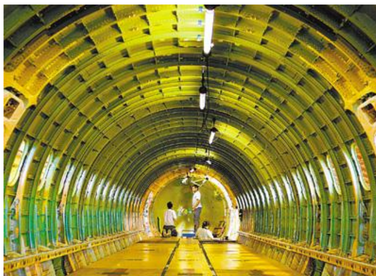
Figura 6 - Selagem da fuselagem para a pressurização da aeronave
