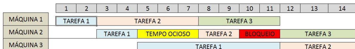
Figura 5 – Exemplo de bloqueio e tempo ocioso em um sistema flow shop
