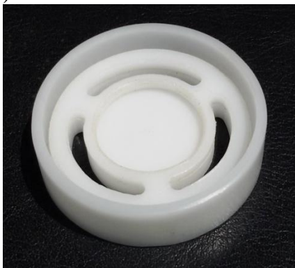
Montagem tampa/revestimento interno da câmara do tipo KfK: (A) Vista em perspectiva; (B) Vista superior.
