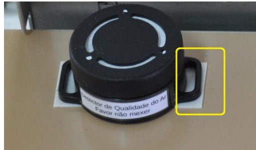
Figura 11 – Câmera do tipo KfK. O retângulo amarelo demonstra a localização de uma das alças de fixação Fonte: Lopes et al. (2014).
