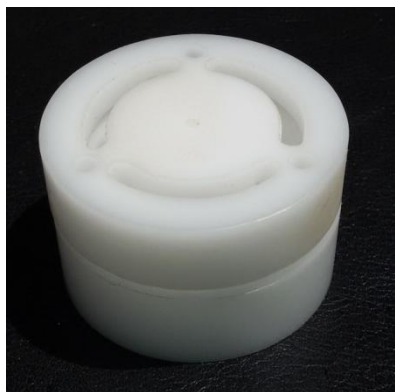
Montagem base/revestimento interno/tampa da câmara do tipo KfK: (A) Vista em perspectiva; (B) Vista superior.
