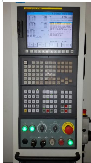
Figura 18 – Sistemas de comando do CNC: (A) Remote panel ; (B) Painel de controle Fonte: Autoria própria.
