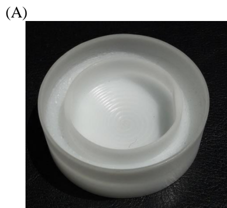
Tampa da câmara do tipo NRPB/SSI: (A) Vista em perspectiva; (B) Vista superior.
