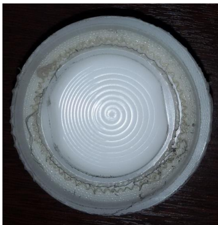
Figura 21 – Componente tampa contendo rebarbas Fonte: Autoria própria.
