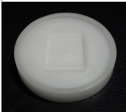
Base da câmara do tipo NRPB/SSI: (A) Vista em perspectiva; (B) Vista superior.
