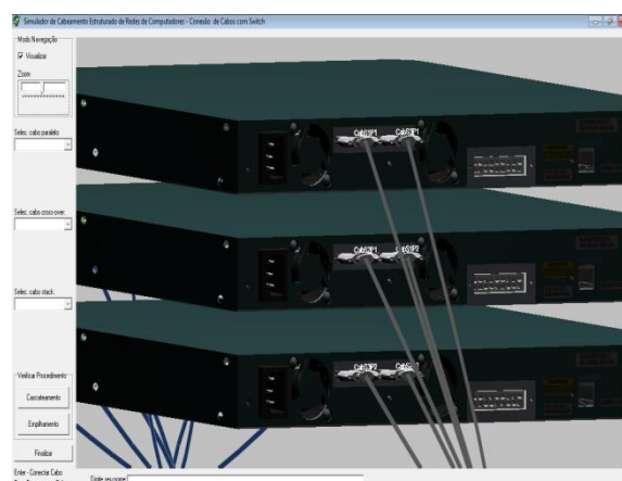
d) Empilhamento de Switches
