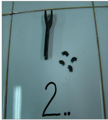
Figura 8 - Condição da peça 4 após o ensaio de tração Fonte: autoria própria.
