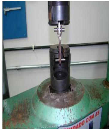
Figura 2 - Ensaio de tração empregando o gabarito de fixação inicialmente proposto
