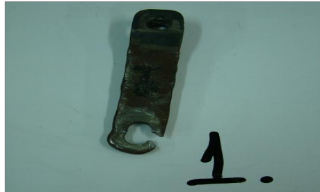
Figura 10 - Condição do elo número 1. após ensaio de tração Fonte: autoria própria.
