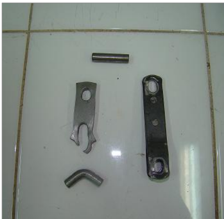
Figura 4 - Condição do gabarito inicialmente proposto após a realização do primeiro ensaio de tração Fonte: autoria própria.
