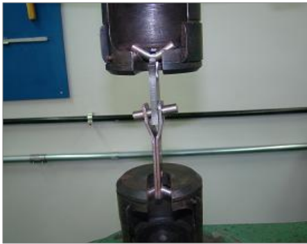
Figura 3 - Estado do corpo de prova após a realização do primeiro ensaio de tração Fonte: autoria própria.
