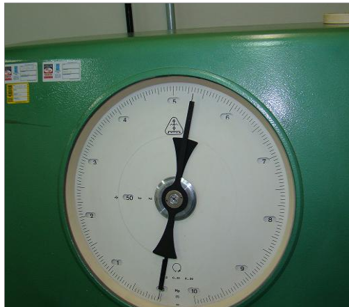
Figura 7 – Tensão máxima verificada no ensaio com o elo número 2. (5350 kgf/mm 2 ) Fonte: autoria própria.
