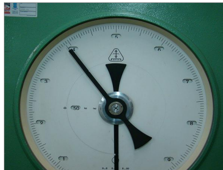
Figura 9 - Tensão máxima verificada no ensaio com o elo número 1. (3950 kgf/mm 2 ) Fonte: autoria própria.
