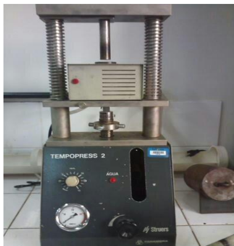
Figura 8 - Embutidora automática Tempopress 2, UTFPR - CP Fonte: Fambrini, 2013
