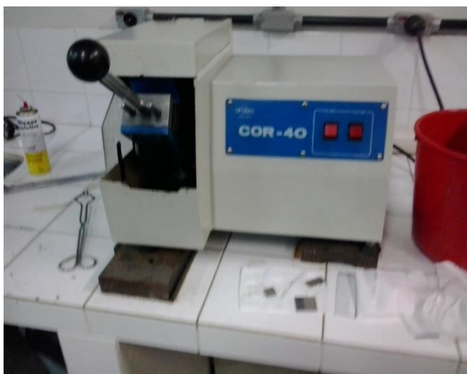
Figura 7 - Cortadora metalográfica AROTEC COR-40, UTFPR-CP Fonte: Fambrini, 2013
