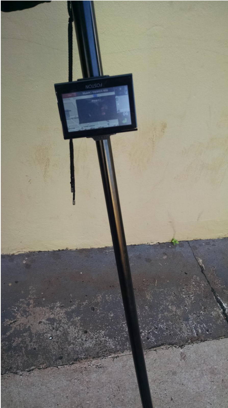
Figura 10 - Imagem Bengala adaptada com GPS.
