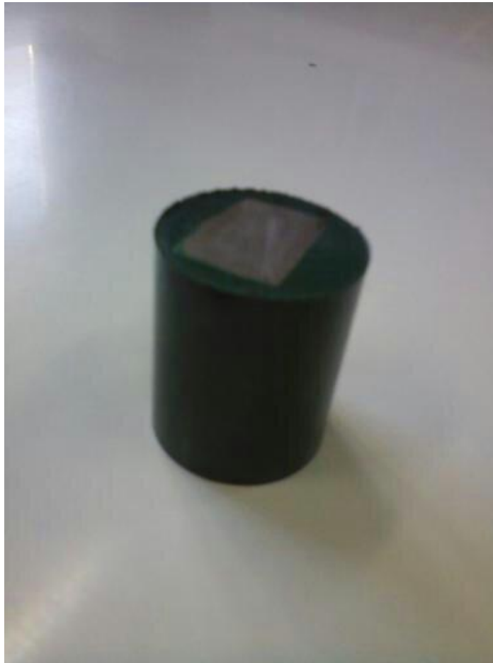
Figura 14 – Corpo de prova embutido sem lixamento e sem polimento. Fonte: Autoria própria
