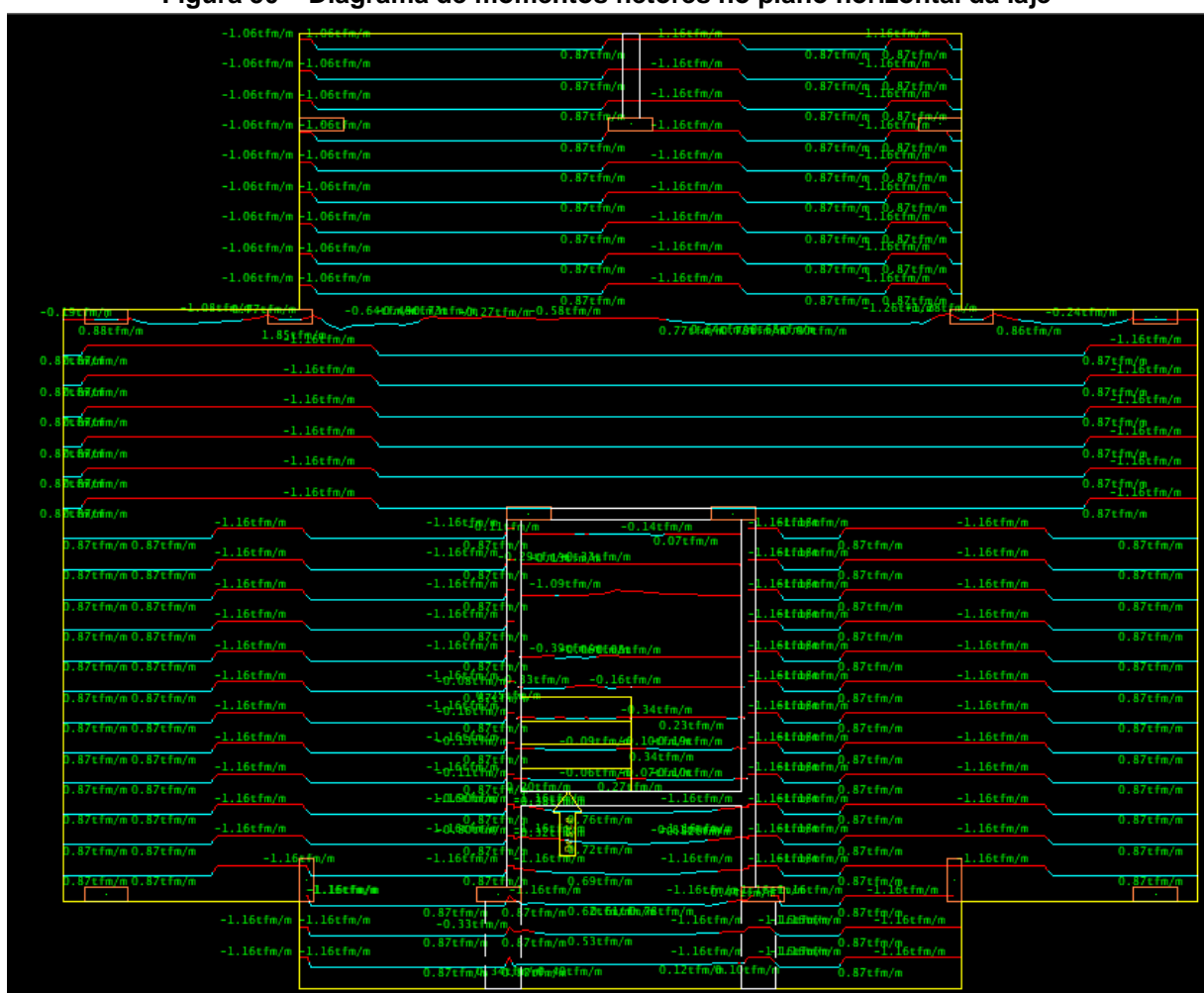
Figura 50 – Diagrama de momentos fletores no plano horizontal da laje
