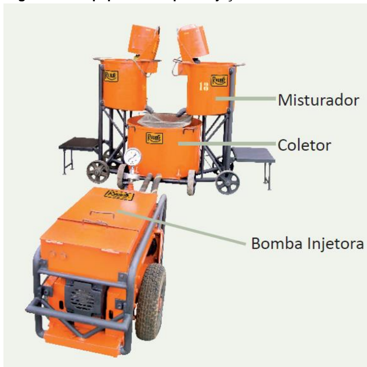
Figura 27 – Equipamentos para injeção de nata de cimento
