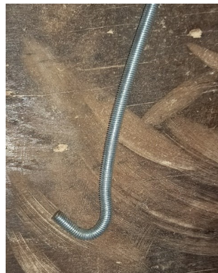
Figura 30 – Execução do gancho na barra roscada de 6 mm.
