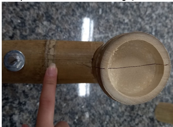
Figura 44 – Ruptura no colmo inferior da ligação T sem argamassa
