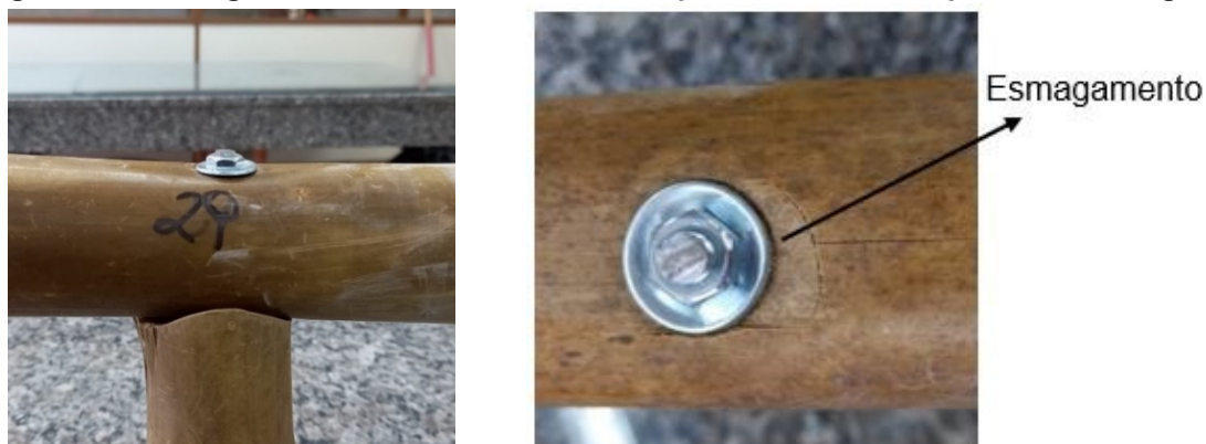
Figura 47 – Esmagamento das fibras do colmo superior no local de aplicação da carga
