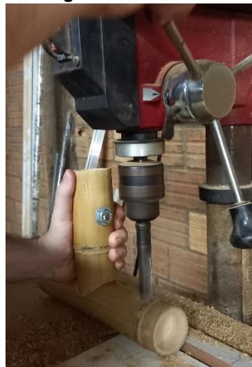
b) Execução do furo na ligação T
