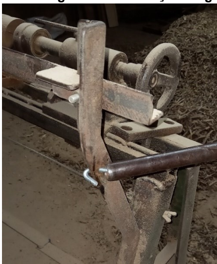
Figura 30 – Execução do gancho na barra roscada de 6 mm.
