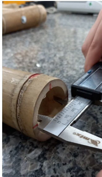
Figura 39 - Medição do diâmetro interno e externo do colmo do bambu
