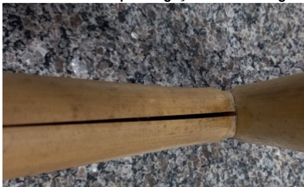
Figura 53 – Modo de ruptura ligações 45° sem argamassa
