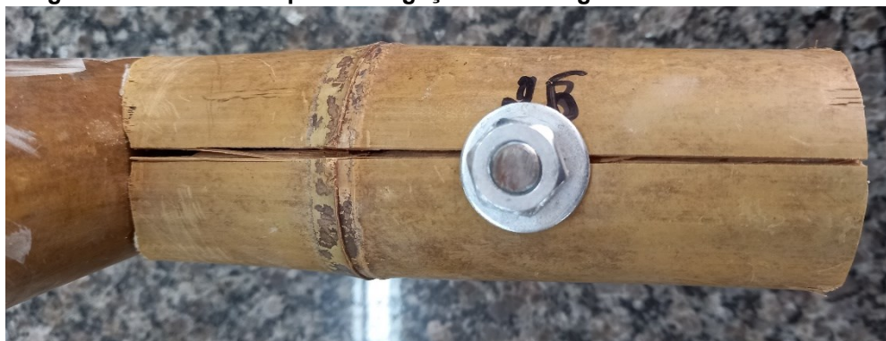
Figura 45 – Modo de ruptura da ligação T com argamassa de areia artificial
