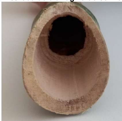
Figura 34 -Retirada do diafragma do colmo de bambu
