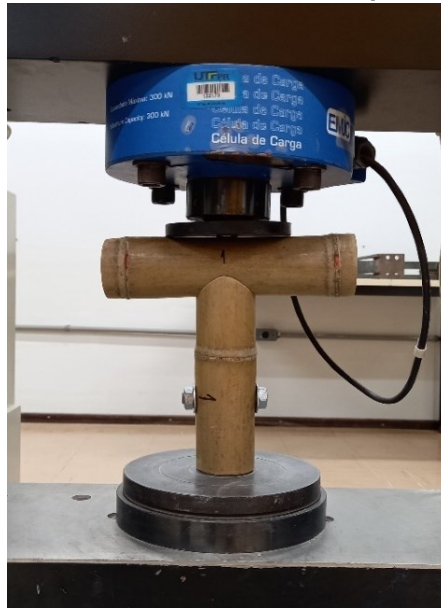
Figura 38 – Ensaio de resistência a compressão ligação T
