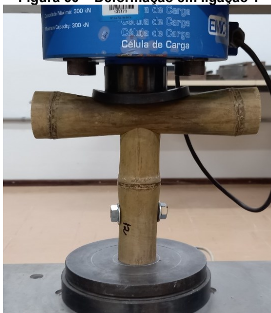
Figura 60 – Deformação em ligação T
