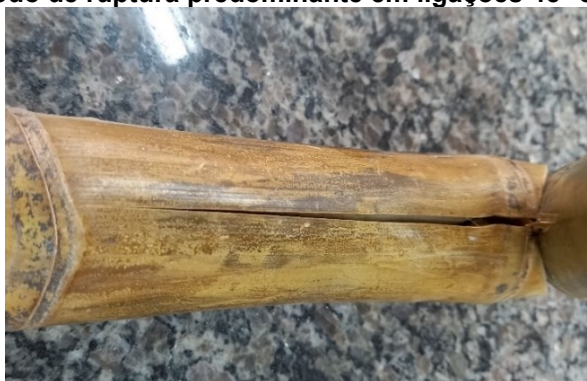
Figura 54 – Modo de ruptura predominante em ligações 45° com argamassa
