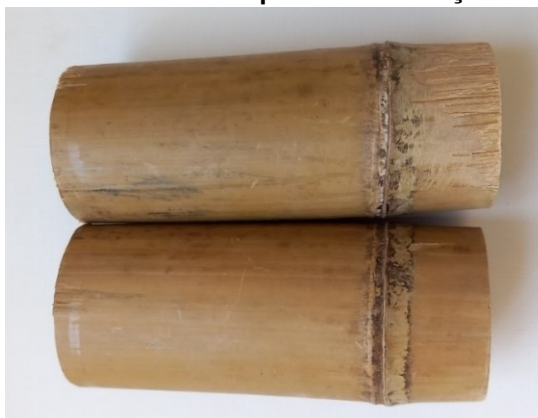
Figura 42 - Colmos de bambu para determinação da densidade
