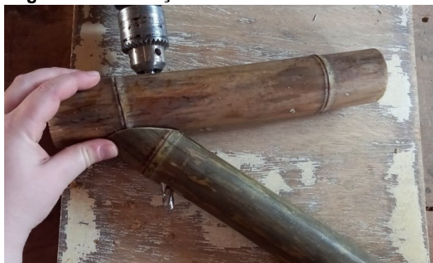
Figura 32 - Execução do furo no colmo inclinado
