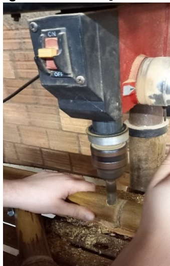
a) Execução do furo na ligação 45°
