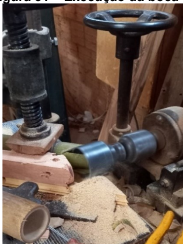
a) Execução da boca de flauta
