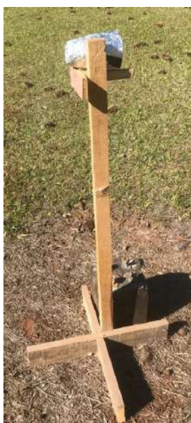
Figura 32: Suporte para medição de temperatura externa Fonte: Aatoria própria (2021).
