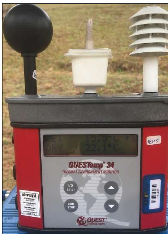
Figura 29: Monitor de estresse térmico da marca Questemp® 34 Fonte: Autoria própria (2021).
