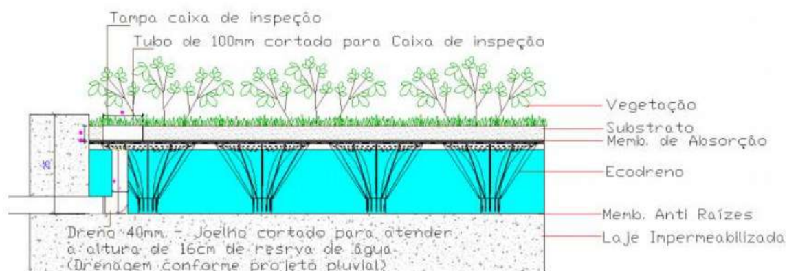
Figura 13: Detalhe Esquemático Sistema Laminar Alto Fonte: Manual e Especificações - Sistema Laminar Alto (2020).
