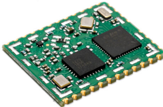
Figura 9 – Dispositivo IM880B-L com comunicação LoRA e GPS para localização.
