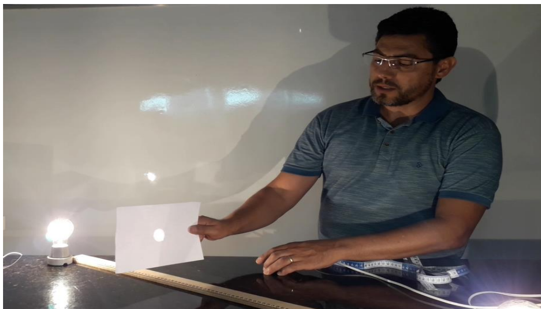
Figura 33: Fotômetro de mancha de óleo, prático (baixo custo)
