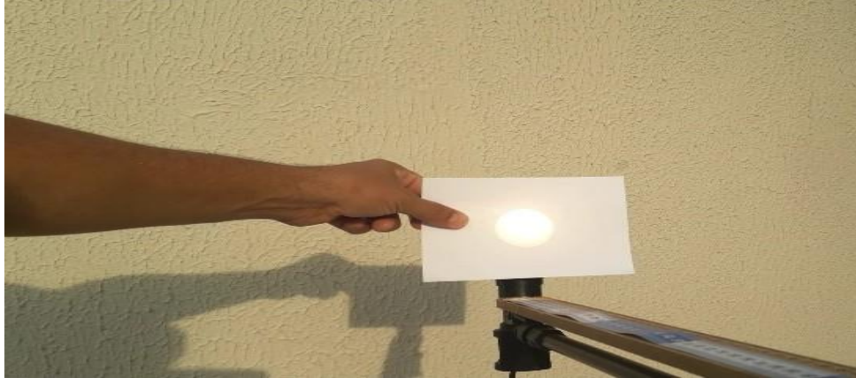
Figura 7: Aplicação do fotômetro de mancha de óleo a tarde: Lâmpada x Sol.
