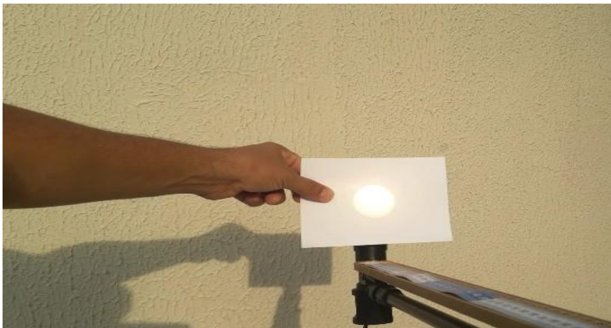
Figura 32.1: Aplicação do fotômetro de mancha de óleo a tarde.
