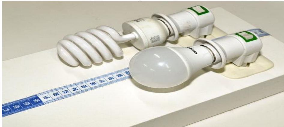
Figura 14: Protótipo: Fotômetro de mancha de óleo com uma lâmpada fluorescente e uma lâmpada de led.
