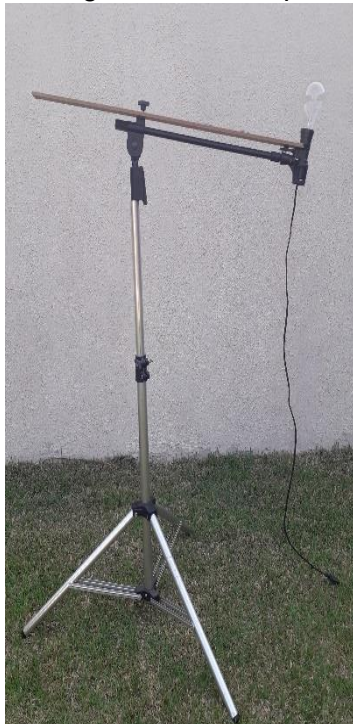
Figura 15: Protótipo: Fotômetro de mancha de óleo para medir a potência do Sol.
