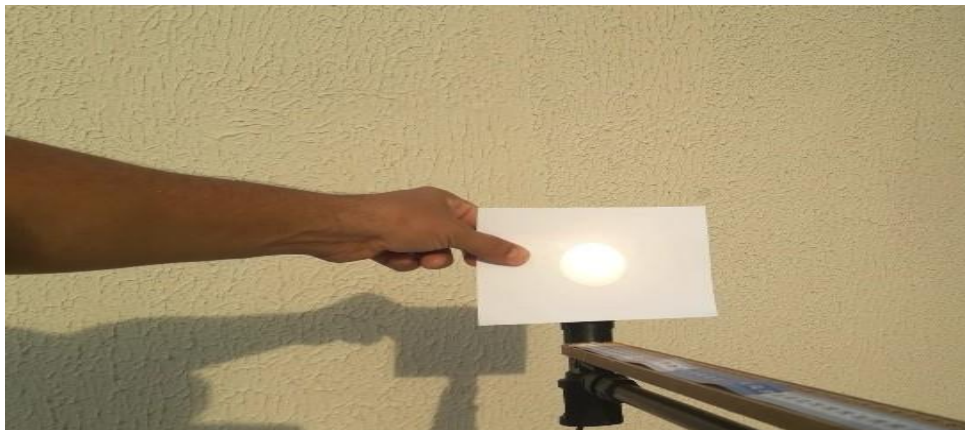
Figura 28: Aplicação do fotômetro de mancha de óleo a tarde: Lâmpada x Sol
