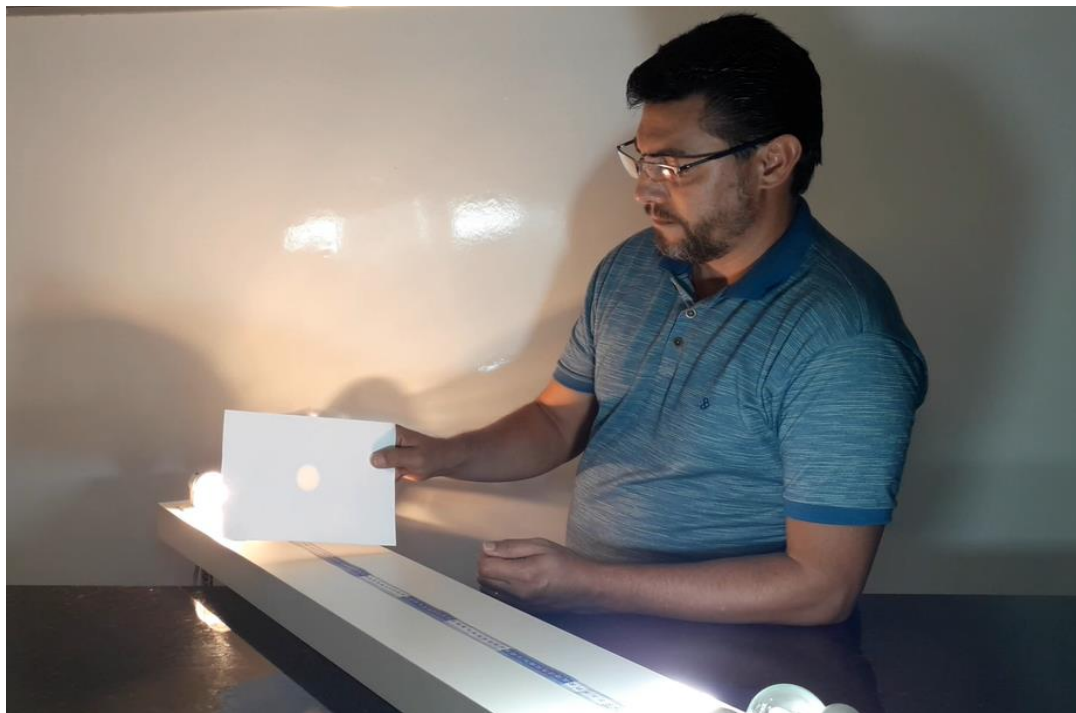
Figura 31: Aplicação do fotômetro de mancha de óleo a noite
