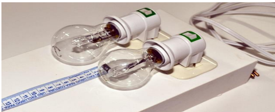
Figura 13: Protótipo: Fotômetro de mancha de óleo com duas lâmpadas incandescentes
