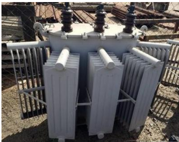
Figura 12: Transformador de Tensão de 225 kVA do fabricante Marangoni
