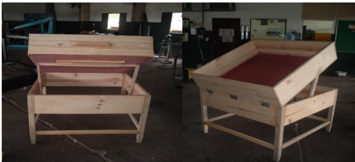
Figura 11- Secador solar de secagem passiva (convecção natural)
