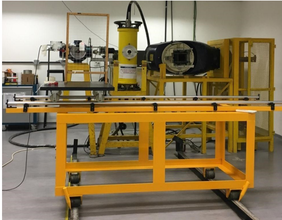
Figura 11 - Fontes radioativas dispostas na sala de fontes do GFMDR-IFUSP. Da esquerda para direita: Fonte de ^{137}\text{Cs} , Tubo de raios X industrial e fonte de ^{60}\text{Co} .
