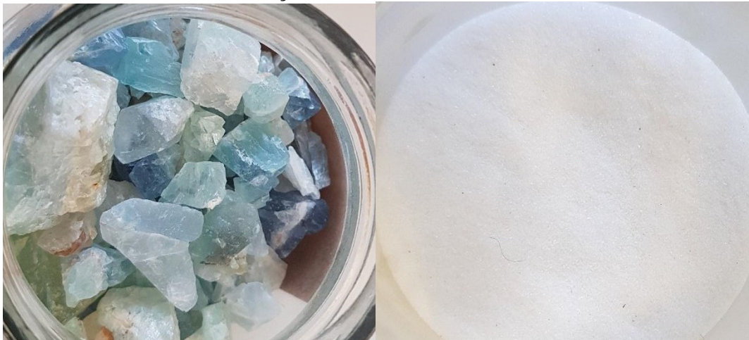
Figura 5 - Fluorita natural (a esquerda) e \text{CaF}_2 em pó (a direita) para tratamento térmico e confecção dos detectores.
