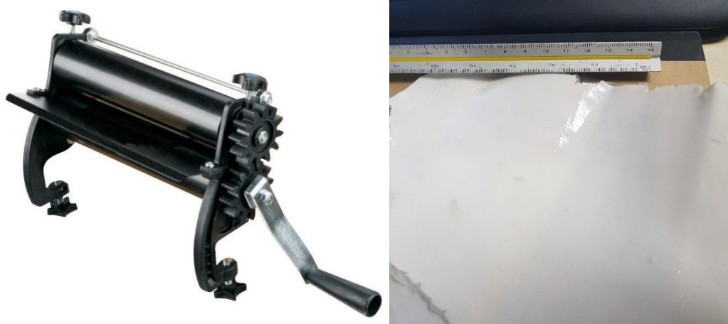
Figura 7 - Laminador de abrir massa utilizado para confecção da folha de detectores (a esquerda) e a folha de detectores a base de CaF 2 com a cobertura de silicone (a direita).
