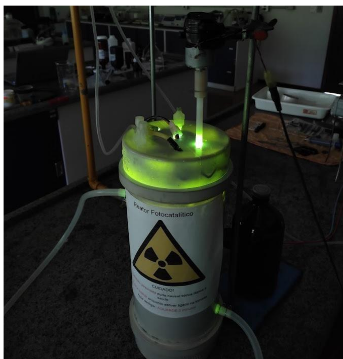
Figura 15 Reator fotocatalítico durante os testes de degradação do corante amarelo reativo BF-4G. Fonte: Autoria própria.
