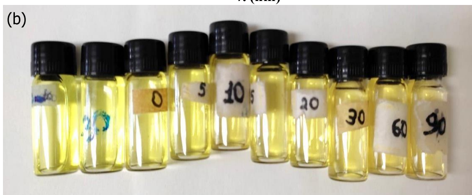
Figura 43 Modificações registradas ao longo do tempo de tratamento fotocatalítico do corante amarelo reativo BF-4G sob ação do fotocatalisador F2T1 na presença de álcool isopropílico: (a) variação dos espectros de absorção no UV-Vis, (b) alteração visual da cor Fonte: Autoria própria.
