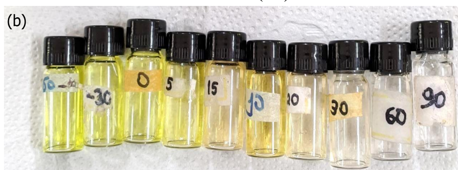
Figura 42 Modificações registradas ao longo do tempo de tratamento fotocatalítico do corante amarelo reativo BF-4G sob ação do fotocatalisador F2T1 sem sequestrante: (a) variação dos espectros de absorção no UV-Vis, (b) alteração visual da cor. Fonte: Autoria própria.
