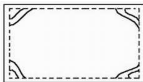
Figura 1 – Fissuras na face superior da laje, provocadas por momentos volventes
