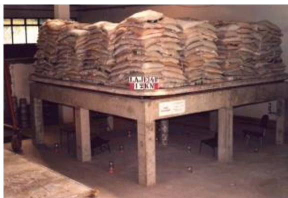
Figura 45 – Carregamento em uma laje com reforço de adição de concreto na face superior
