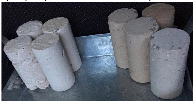
Figura 26 – Corpos de prova após serem resfriados naturalmente, à esquerda, e bruscamente, à direita.
