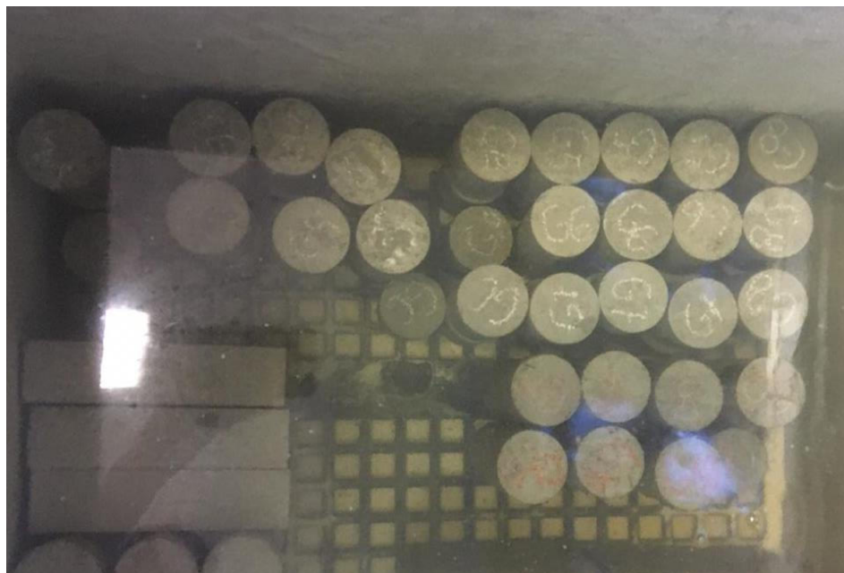
Figura 19 - Corpos de prova em solução saturada de hidróxido de cálcio para cura.
