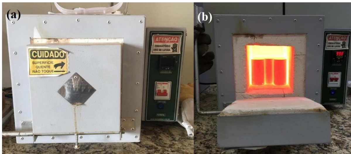
Figura 21 – (a) Forno Mufla MARQLABOR MAQMUF2-RP; (b) Corpos de prova expostos a 1000 °C.
