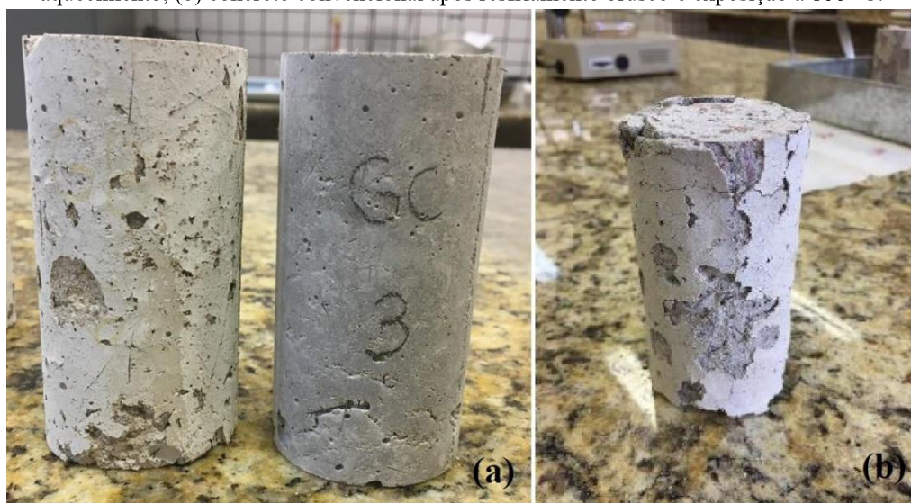
Figura 34 - (a) CRFA após exposição a 800 °C e resfriado bruscamente ao lado de CRFA não submetido ao aquecimento; (b) concreto convencional após resfriamento brusco e exposição a 800 °C.
