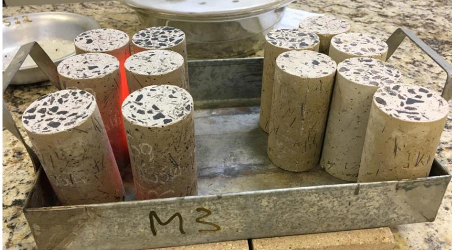
Figura 24 - Corpos de prova no início do ensaio de resfriamento. Grupo G9 à esquerda e grupo G10 à direita.
