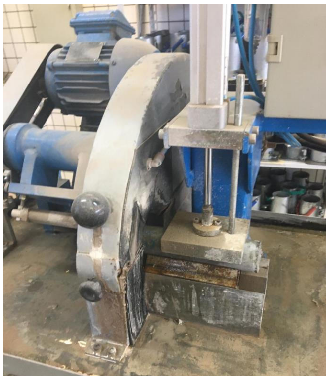
Figura 20 – Corpo de prova durante retificação para nivelamento da superfície.
