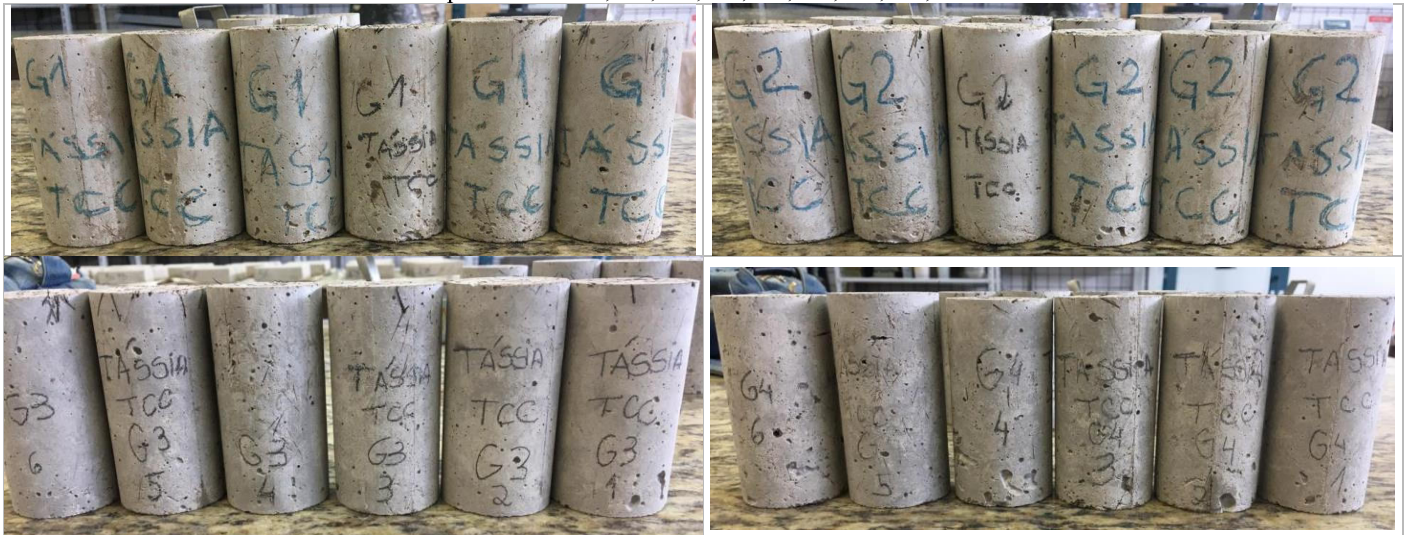
Figura 33 - Concreto reforçado com fibra de aço após ensaio de resfriamento. Da esquerda para a direita e de cima para baixo: G1, G2, G3, G4, G5, G6, G7, G8, G9 e G10.
