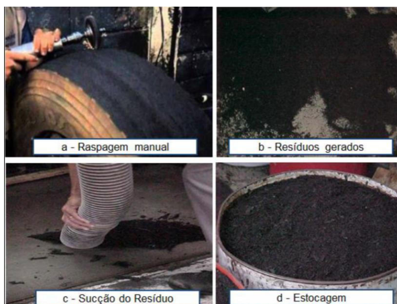
Figura 12 - Processo de obtenção do CRP
