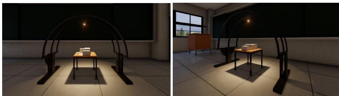
Figura 18 e 19 – Simulação – Heliodon finalizado
