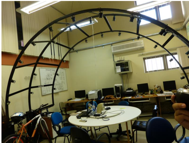
Figura 10 – Heliodon com 3 arcos móveis e mesa fixa
