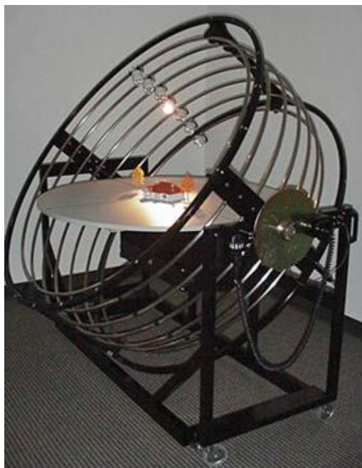
Figura 9 – Heliodon de anéis móveis e mesa fixa
