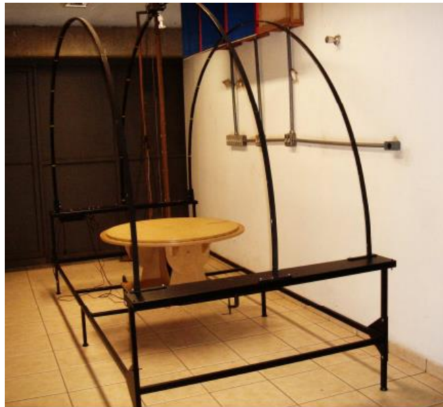
Figura 11 – Heliodon de arcos fixos e mesa inclinável
